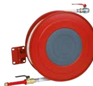
I naspi antincendio sono costituiti essenzialmente da una valvola di intercettazione collegata alla rete idrica in pressione, tubazione semirigida e lancia. La tubazione è avvolta su una ruota mobile con alimentazione assiale.
