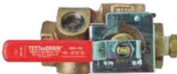
Per impianti sprinkler ad umido per la prova dell'indicatore di flusso e del relativo allarme nonché per lo scarico dell'impianto. Va installato sulle derivazioni principali subito dopo l'indicatore di flusso.
